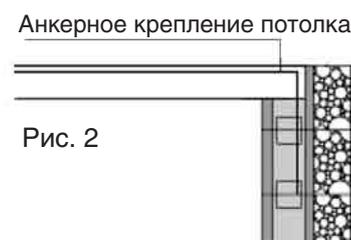
При использовании балочной конструкции перекрытия (рис. 3) перед бетонированием в блоках вырезаются карманы для установки балок. Опорные концы деревянных балок необходимо изолировать и укрепить в бетонном каркасе. На бетонном каркасе устанавливается стягивающий арматурный пояс, который в местах карманов необходимо усилить.
